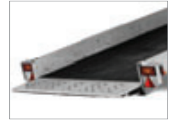
Durch kippbare Ladefläche und niedrigen Rampenwinkel leicht zu befahren - nur 12°.
