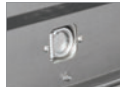
Integrierte Verzurrösen bis max. 400 daN
