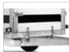
Alle Modelle mit abklappbarer Frontbordwand ausgestattet.
