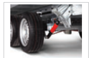
Stoßdämpfersatz Tempo 100 km/h (Eintragungspflicht)
