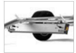
Die Lichtleiste ist abklappbare für leichtes Be- und Entladen.
