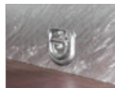
Integrierte Verzurrösen bis max. 400 daN
