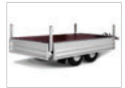
Alle 4 Bordwände sind serienmäßig abklappbar
